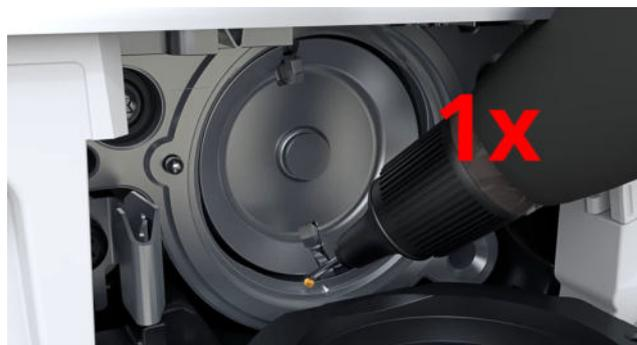
8. Je einen Tropfen BERNINA Nähmaschinen-Öl in die beiden Öldepots geben, sodass die Filze feucht sind. Sicherstellen, dass die Greiferhülsen-Fläche ölfrei bleibt.
