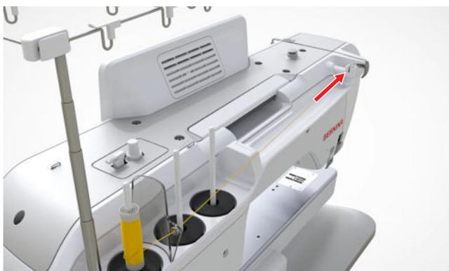
3. Faden wie beim Einfädeln der Einzelnadel bis zur Nadel führen. [▶ siehe Seite 35]
