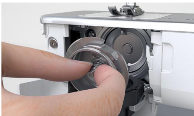
10. Den Greifer mit der Unterkante voraus schräg von oben nach unten hinter den Greiferbahndeckel führen.
