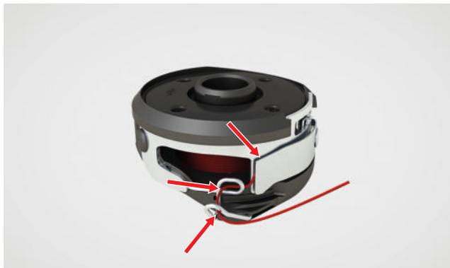
10. Zum Einsetzen der Spulenkapsel, die Spulenkapsel so halten, dass der Draht der Fadenführung nach oben zeigt.
