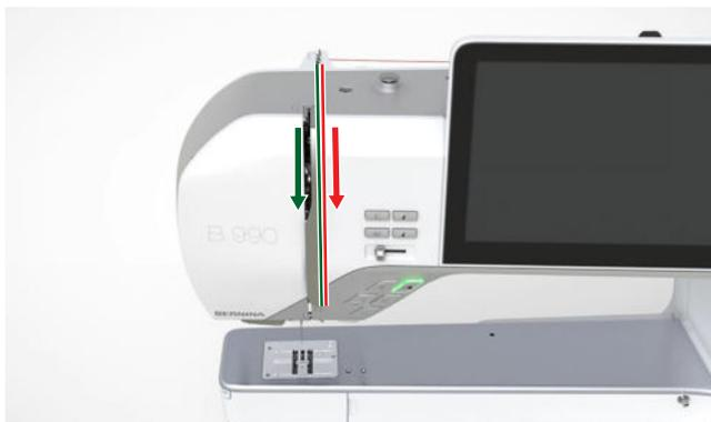
4. Fäden wie beim Einfädeln der Einzelnadel bis zur Nadel führen.
