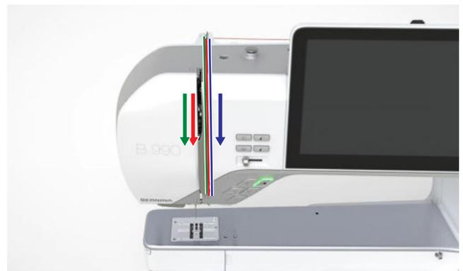
4. Fäden wie beim Einfädeln der Einzelnadel bis zur Nadel führen.
