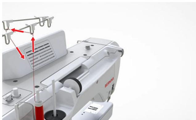
6. Faden von rechts nach links durch die Fadenöse führen.
