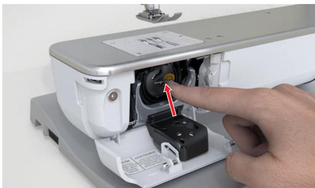
6. Spule aus der Spulenkapsel entfernen.
