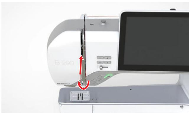
10. Faden durch den Fadengeber ziehen und nach unten führen. Dabei sicherstellen, dass der Faden unter die linke Seitenblende geführt wird.
